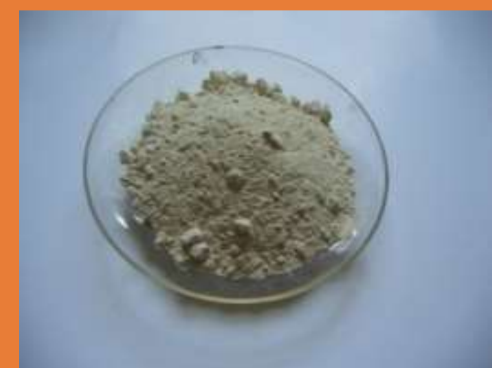
Zgura metalurgică (tratament secundar)
