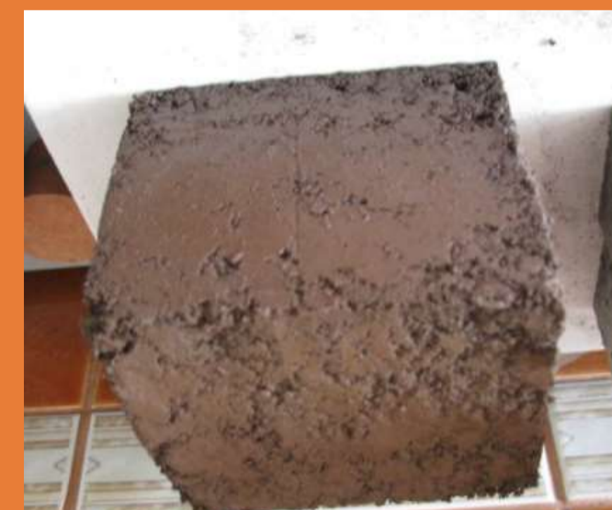
Epruvetă obținută prin stampare
