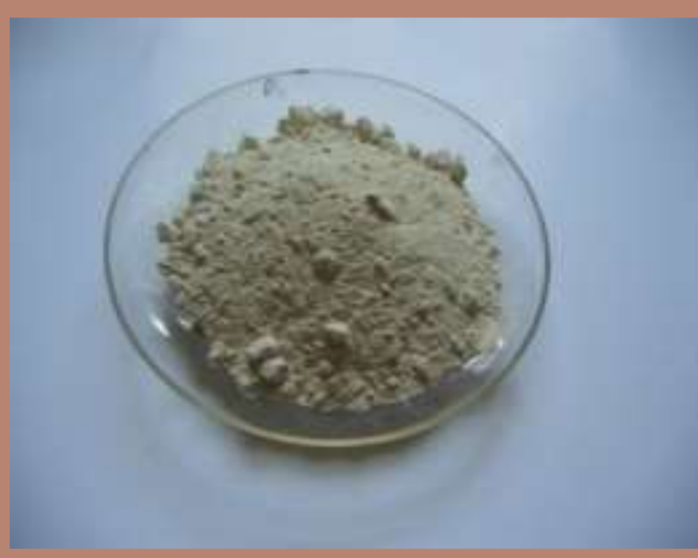
Zgura metalurgică (tratament secundar)
